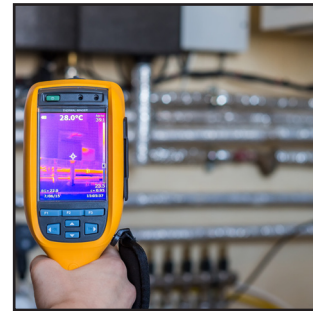
Izquierda: Inspección termográfica de cuadros eléctricos y conexiones. Derecha: Chequeo de aislamiento y tensiones eléctricas.
